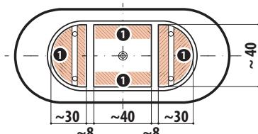
(1) zona posizionamento scarico - (1) drain positioning area
