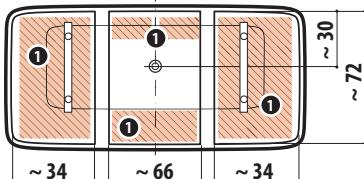
(1) zona posizionamento scarico - (1) drain positioning area
