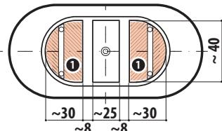
(1) zona posizionamento scarico - (1) drain positioning area
